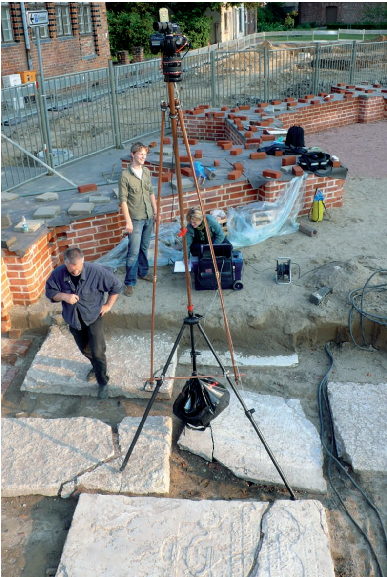
Abb. 15. Hansestadt Wismar, Marienkirche, Dokumentation der Grabplatten im Streiflicht mit einer lotrecht darüber positionierten Kamera, 2007.
